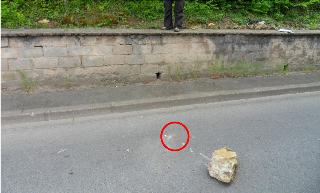
Photo 8 : Petit bloc chuté de 0,01 m 3 de volume. Le cercle rouge représente le point d'impact sur la route.
