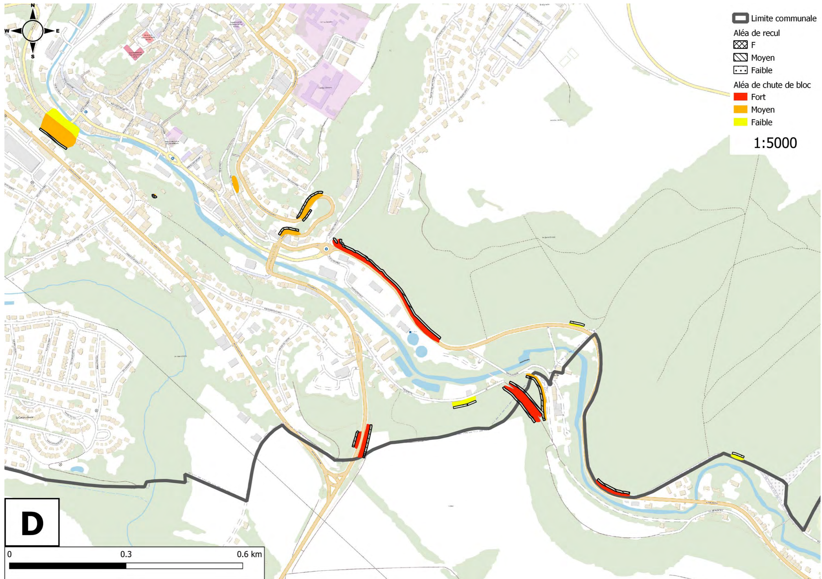
Illustration 144 – Cartographie de l'aléa chute de blocs sur la commune du Val de Briey, partie sud de Briey (fond plan OSM)
