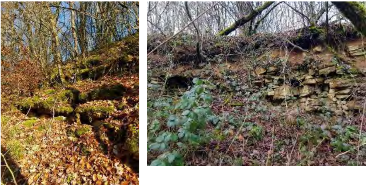
Illustration 23 – Exemple d'un versant rocheux en escalier (Affleurement A22 à gauche) et de l'état de fracturation et d'altération des calcaires en surface (Affleurement A42 droite). BRGM (2021)
